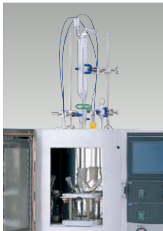
加熱、還流、撹拌、添加 サンプリング(装置停止時) 合成スケール：30~200mL
